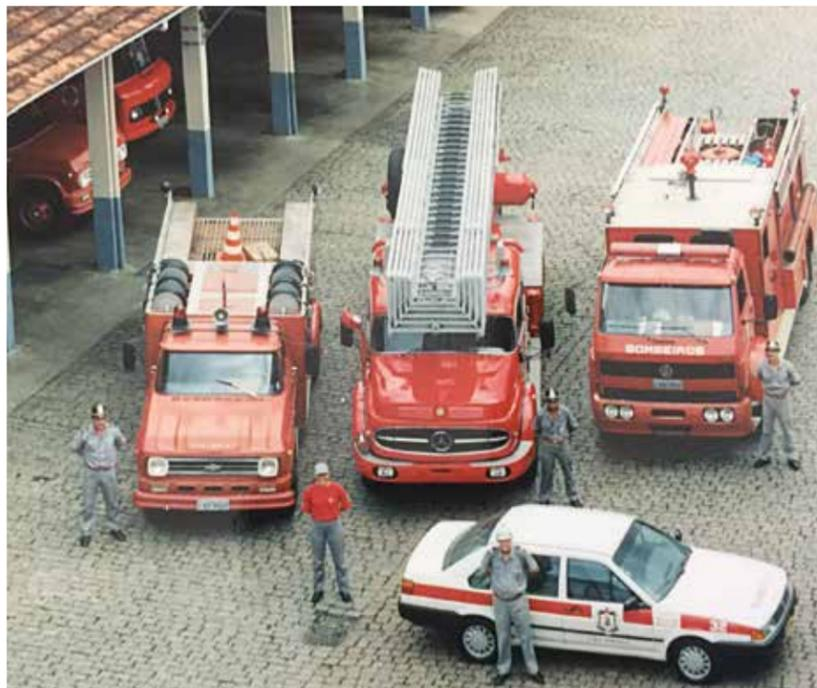
Parte da frota durante os festejos do primeiro centenário. Em destaque o automóvel do comando, caminhão 23, auto escada mecânica 27 e o caminhão de combate hidro químico 09 construído pelos bombeiros de Joinville.
