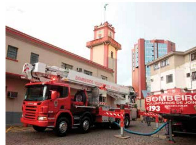
Plataforma elevatória no pátio dos Bombeiros Voluntários de Joinville sendo acoplada ao caminhão tanque.
