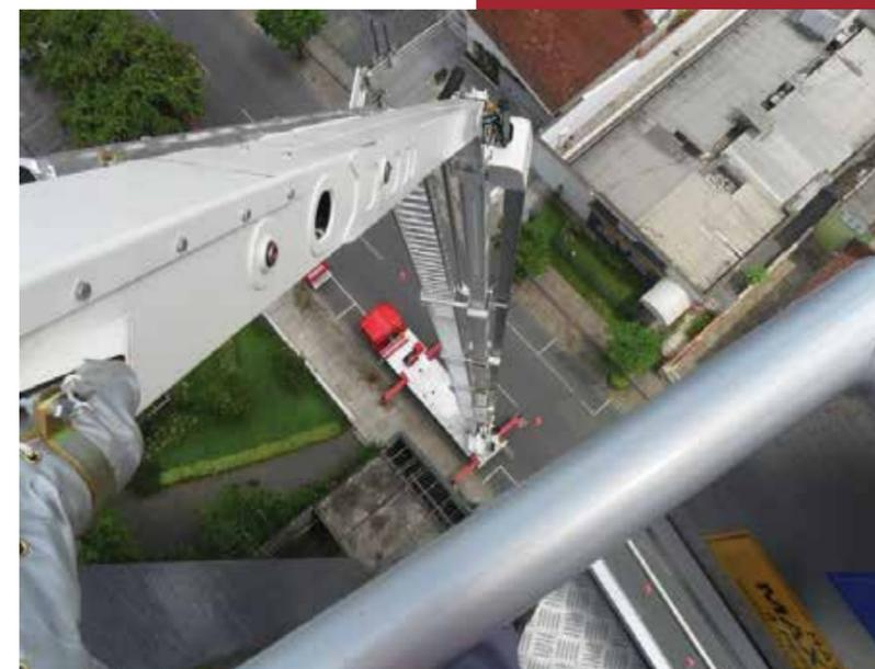
Vista a partir de 54 metros de altura, ponto mais alto da plataforma Bronto Skylift F54 HDL, fabricado na Finlândia em chassi Scania .
