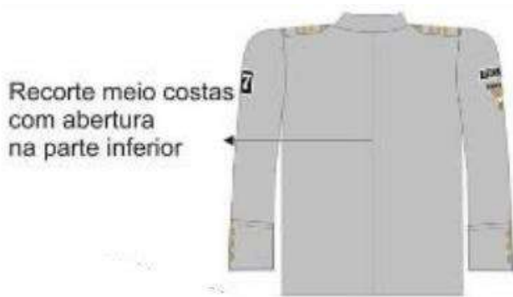
Figura 32: Ilustração do lay out e detalhes construtivos do paletó do uniforme tipo D na parte traseira
